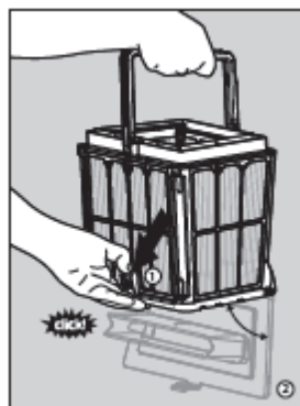
6.1.4 Nyissa ki a reteszt az alsó fedél kioldásához és a törmelék eltávolításához.
